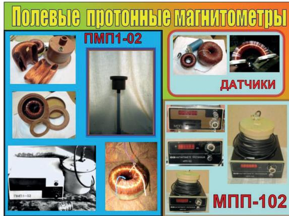
Рис. 1. Полевые протонные магнитометры ПМП1-02 и МПП-102
