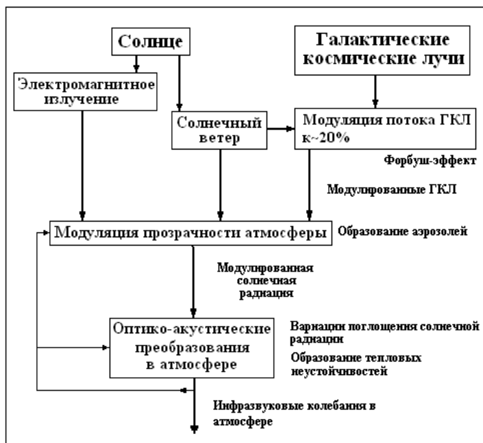
Рис. 2. Сценарий образования инфразвука в атмосфере под действием солнечного излучения, СКЛ и ГКЛ (Сорока, Калита, 2004).
